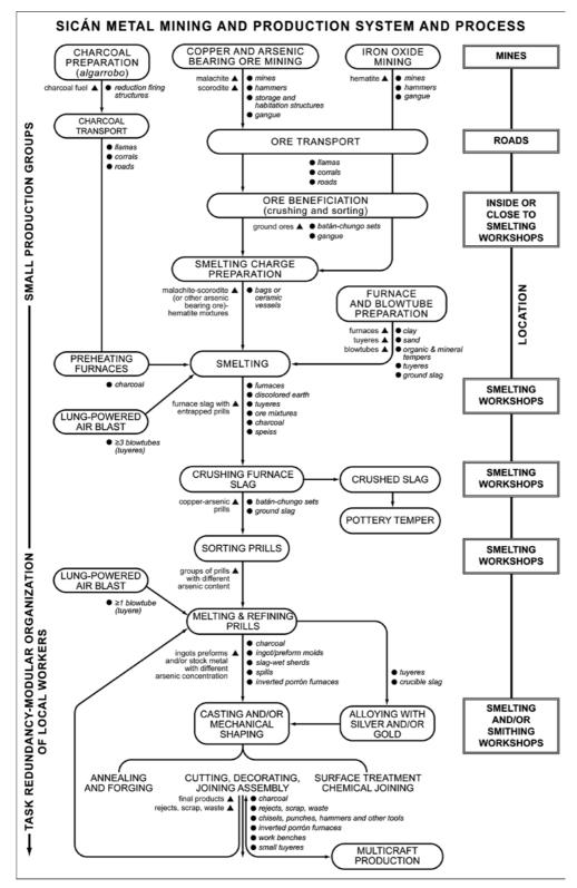
Figure 20. *Châine opératoire* of the Sicán metallurgical process. Drawing by Izumi Shimada and Steve Mueller. Châine opératoire (*secuencia de operación*) *del proceso metalúrgico Sicán. Dibujo de Izumi Shimada y Steve Mueller*.
