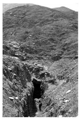
Figure 13. Trench left behind after removal of the discovery vein at the Cerro Blanco mine. Looking east. Photo by Izumi Shimada. Una zanja grande que resultó de la explotación antigua de la veta ("discovery vein") en la mina de Cerro Blanco. Mirando hacia el este. Foto de Izumi Shimada.
